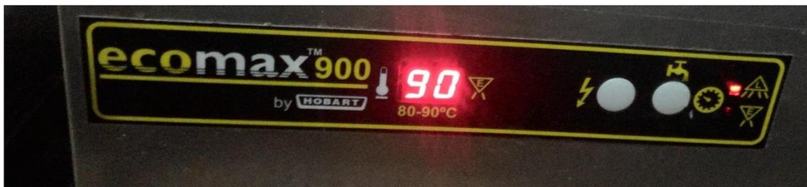
**Figura 12:** Temperatura da Máquina de Lavar louças.
