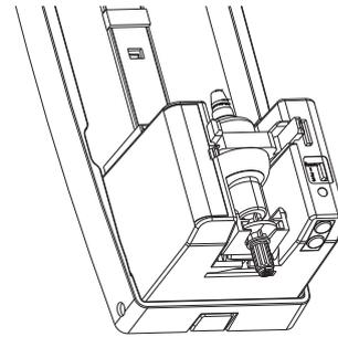
Pressione o botão para ajustar entre as 3 opções de dosagem. Um LED vermelho indica a posição escolhida. Feche o dosador. Está pronto para ser usado!
