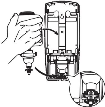
Coloque o reservatório/refil sobre o mecanismo com a válvula voltada para frente e para baixo; em seguida, encaixe os braços da válvula na ranhura do mecanismo. Certifique-se de que a ponta da válvula está encaixada na abertura do acionador (meio disco). Feche a saboneteira. O indicador LED piscará em VERDE uma vez e estará pronto para ser usado.
