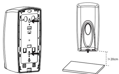
No local desejado, segure o dosador contra a parede. Abra a tampa e marque o local dos furos. Providencie os furos na parede (broca x mm) e fixe o dosador com as buchas e parafusos fornecidos. Instalar no mínimo a 20cm de altura de qualquer superfície horizontal. Importante: ao fazer o furos cuidado para não atingir tubulações hidráulicas ou elétricas.
