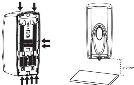
A fita adesiva já vem aplicada no dosador. Limpe a superfície com o lenço de álcool (fornecido) e espere secar. Fixe o dosador na superfície. Deixe aderir por 1 hora antes de abastecer o dosador. Instalar no mínimo a 20cm de altura de qualquer superfície horizontal. Importante: escolha uma parede com acabamento liso, sem imperfeições ou rugosidades.
