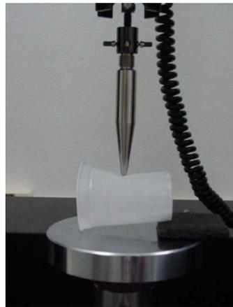
**Figura 2 - Ilustração do posicionamento do copo para o ensaio de resistência à compressão lateral**
